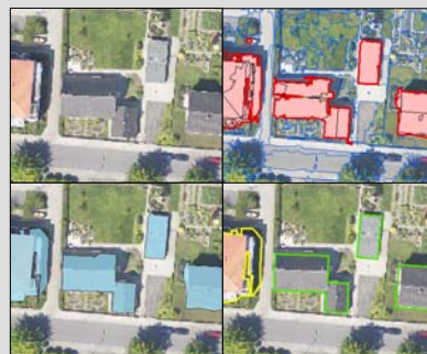
Abb. 5: Glättung der Gebäudestrukturen: Luftbild (oben links), Klassifikationsergebnis (oben rechts), Glättung mit ALK (unten links) Glättung mit MBR- Ansatz (unten rechts, grün: bereinigte Gebäude, gelb: nicht bereinigt)
