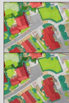
Abb. 6: Klassifikationsergebnis vor (oberes Bild) und nach (unteres Bild) der Bereinigung mit ALK Daten
